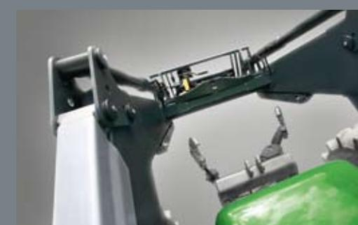
**SCHLAUCHSCHUTZ.** Der Schutzüberzug schützt die Hydraulikschläuche vor Verschleiß, Verschmutzung, Stöße, Sonnenlicht etc. Zusätzlich werden die 4 Schläuche kompakt zusammen gebündelt, die Sicht nach vorne wird hierdurch verbessert und das Verdecken von Signalleuchten erheblich vermindert. Jetzt Serienmäßig bei allen Quicke Dimension Frontladern.
