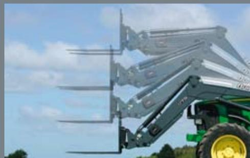
**Q LINK – EXAKTE PARALLELFÜHRUNG.** Q Link ist die Bezeichnung für effektive Parallelführung. Die Palettengabeln sind von Bodenposition bis maximaler Höhe immer in der richtigen Stellung. Die robuste Konstruktion ermöglicht überlegenes Arbeiten mit z. B. Stroh oder Paletten. Wenn Sie mit der Schaufel arbeiten, bleibt genau dieselbe exakte Parallelführung bestehen, ohne dass am Lader irgendwelche Einstellungen erforderlich sind.
