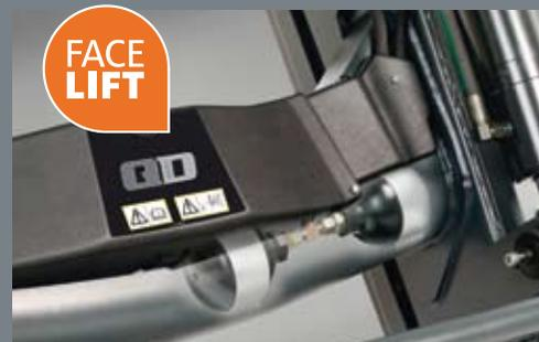
**ULTRABEQUEMER SOFTDRIVE.** Fahren Sie so hart Sie wollen auf denkbar sanfteste Art. Die innovative Dämpfungsfunktion verringert Belastungen von Lader und Anbaukonsole sowie von Fahrer und Traktor. Das SoftDrive wird natürlich bequem vom Traktorsitz mit elektrischer Ein-/Aus Funktion aktiviert.
