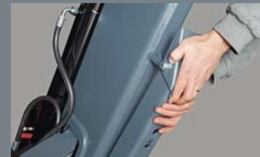
**FELSENFESTE ABSTELLSTÜTZEN.** Dank robust ausgelegten, dabei elegant geformten Abstellstützen kann der Quicke-Lader einfach und schnell Werkzeuglos angebaut und auch wieder abgestellt werden.
